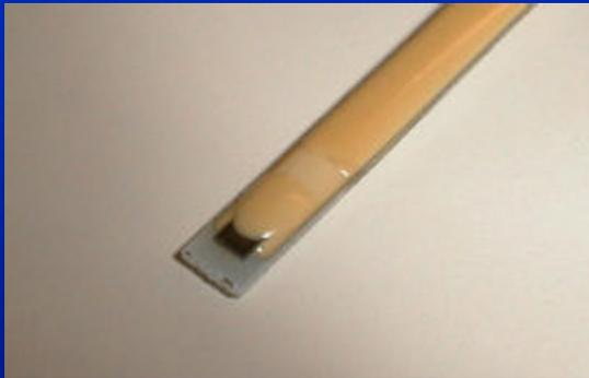
*BSOI ISFET encapsulado para pruebas de aislamiento eléctrico*
