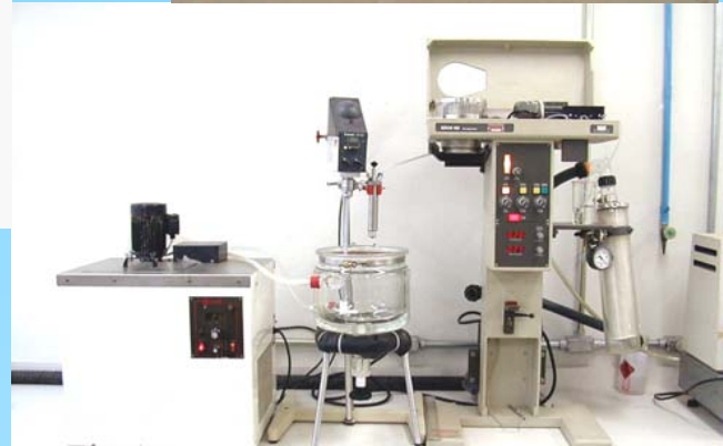
Reator para complexação iônica
